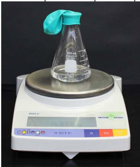
4. Sin retirar el sistema de la balanza, permita que caiga el  $\text{NaHCO}_3$  en el matraz. Una vez terminada la reacción (cuando ya no se observe desprendimiento de gas), pese nuevamente el sistema. El valor obtenido será  $m_2$ .
