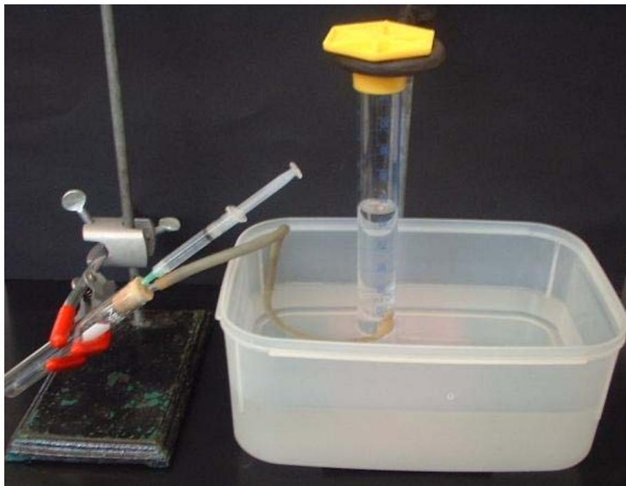
2. Adicione 0.5 [ml] de la disolución comercial de ácido clorhídrico al tubo de ensayo, utilizando para tal fin una jeringa, con la cual perforará el tapón de hule para adicionar el ácido.
