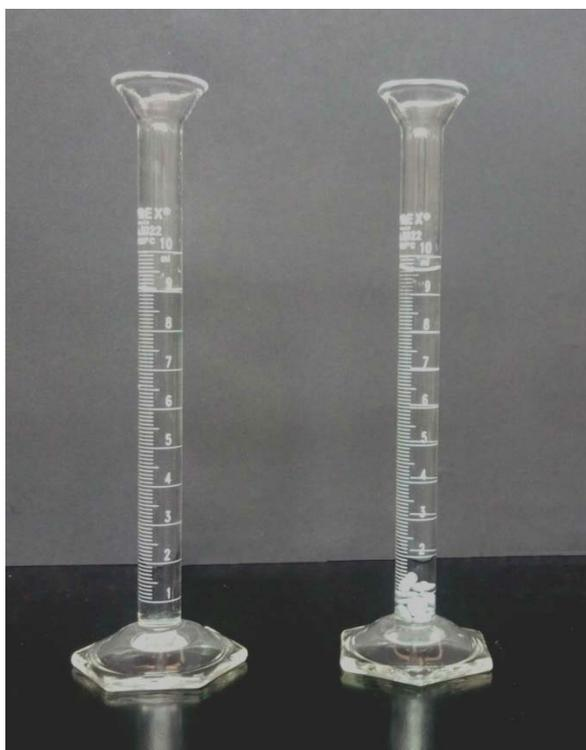
5. Determine la masa de la probeta con los 9 [ml] de agua y las piezas metálicas ( $m_2$ ).
