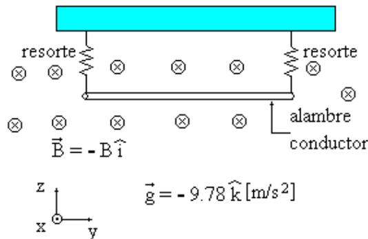
Adicionalmente, en el mismo campo magnético se coloca un alambre de 2 [mm] de diámetro, 17 [cm] de longitud y densidad  $\rho = 8.96$  [g/cm<sup>3</sup>] como se muestra en la figura. Considerando que  $g = 9.78$  [m/s<sup>2</sup>] determine en el SI:
