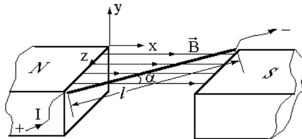
8. Un alumno de Física Experimental realizó la práctica de electromagnetismo en un laboratorio, tomando como datos el incremento aparente de masa del imán y la intensidad de corriente eléctrica correspondiente. Parte de las mediciones se muestran en la tabla. Si el conductor estaba colocado perpendicularmente a las líneas de campo magnético del imán utilizado, como se muestra en la figura, y la aceleración gravitatoria del lugar era  $g = 9.8$  [m/s<sup>2</sup>], determine :
