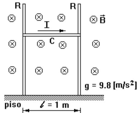
6. En un experimento en el laboratorio se midió el ángulo  $\gamma$  (ángulo entre conductor de cobre y las líneas de campo magnético) y la fuerza de origen magnético  $F_m$  que experimentaba dicho conductor el cual transportaba una corriente eléctrica de 2.5 [A]. Se sabe que la masa del conductor era de 2 [g], tenía 1.8 [mm] de diámetro y su densidad era  $\rho_{Cu} = 8.93$  [kg/dm<sup>3</sup>], con base en ello determine:
