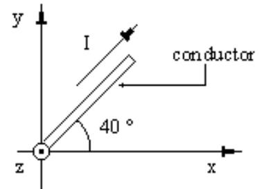
13. En un experimento de electromagnetismo se colocó un conductor dentro de un campo magnético generado por un imán en forma de herradura, como se muestra en la figura. El conductor de 9.5 [cm] estaba colocado en el plano  $xy$  formando un ángulo  $\phi = \pi/6$  [rad] con respecto a las líneas de campo magnético. Se varió la corriente eléctrica ( $i$ ) en el conductor y se midió en forma indirecta la fuerza magnética ( $F$ ) sobre el mismo. Determine, en el SI:
