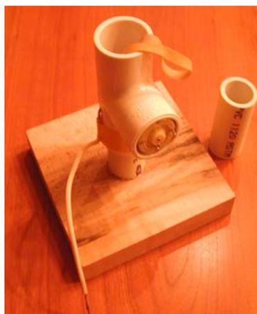
El conector T de PVC sujetará el pequeño motor. Para sujetar al motor es mejor envolver alrededor algo de cinta aislante. Se puede dejar el eje tal como está, pero es mejor ponerle algo de cinta aislante o un tubito de plástico para que actúe como polea para la banda de
