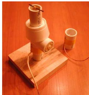
El tubito de vidrio no tiene imperfecciones y no se romperá fácilmente. El siguiente paso es un poco difícil: metemos el clavito por uno de los agujeros en el tubo, luego se introduce el tubito de vidrio, después la banda de goma que debe estar sobre el tubito de vidrio y finalmente metemos el clavito en el orificio del frente. La banda de goma debe girar sobre el tubito de vidrio y este girar sobre el clavito.
