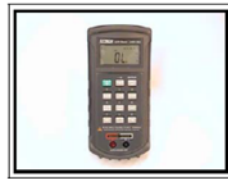
Foto 2. Puente de impedancias.
