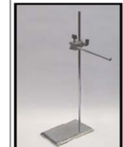
Foto 4. Soporte universal, tornillo de sujeción y varilla de aluminio.
