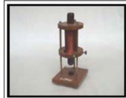
Foto 7. Solenoide de 800 vueltas y núcleo recto de acero.
