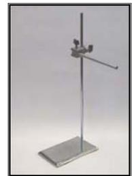
Foto 8. Soporte universal, tornillo de sujeción y varilla de aluminio.
