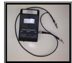
Foto 12. Electrómetro.
