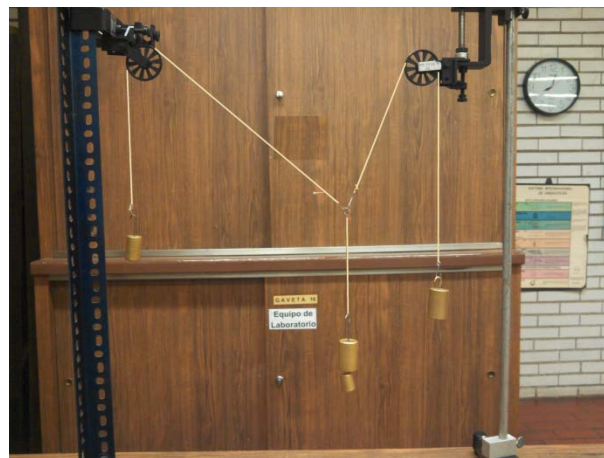
Figura 4 Arreglo de dos cuerdas con un cilindro de 200 g, uno de 100 g y los otros dos de 200 y 50 g.
