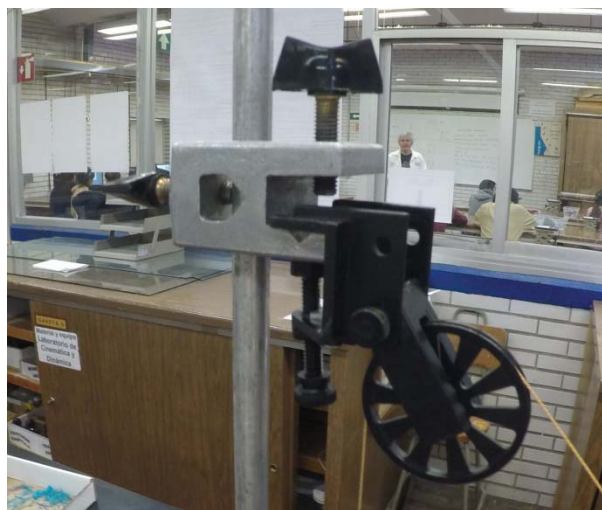
Figura 2 Mordaza doble con una polea de plástico, sujeta a la varilla vertical con base.
