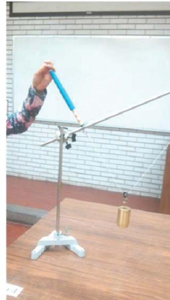
Figura 3 Forma de medir tensiones en un hilo.
